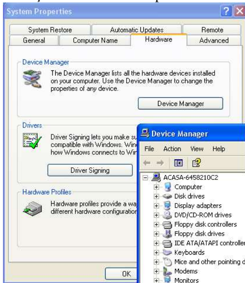
Fig. 2.6 Gestionarul de dispozitive furnizează detalii despre componentele instalate în calculator și modurile de funcționare
